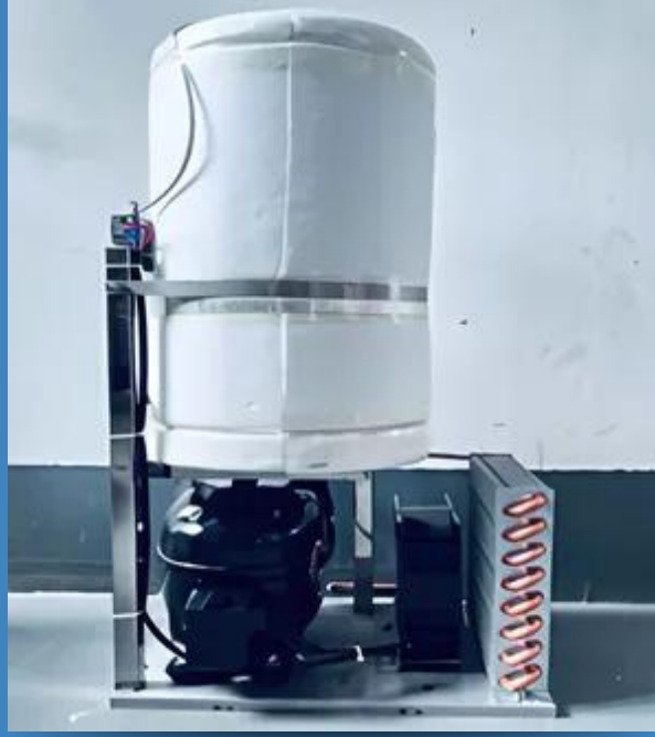
الضاغط وخزان التبريد (18 لتر) - داخل الآلة التفاصيل: عمل ماء بارد
